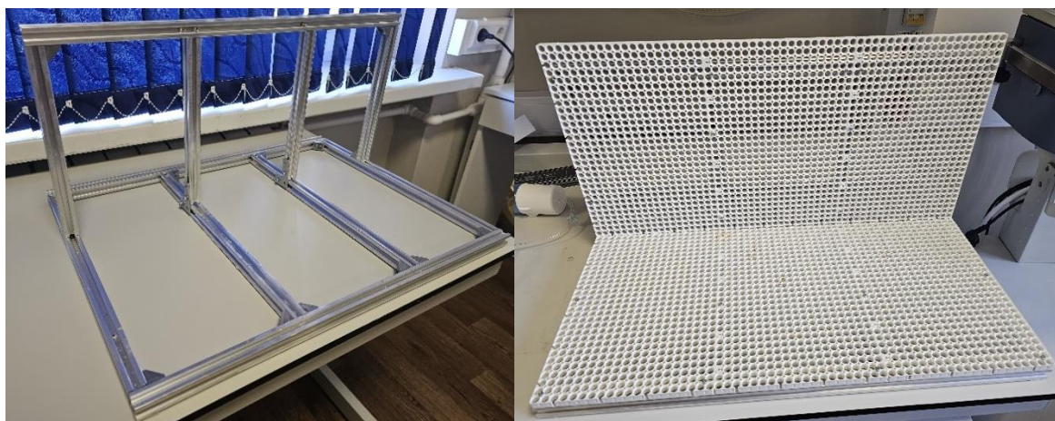
Рисунок 4. внешний вид стенда установки (А – рама из конструкционного профиля Б – стенд в сборе).
