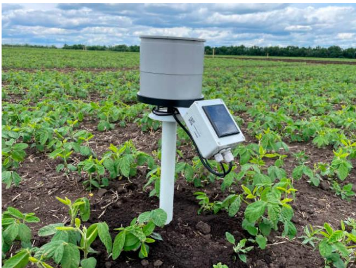
Рисунок 3 - Агрометеорологическая станция и сопряжённая с ней почвенная станция NERO развернутая на поле №7
