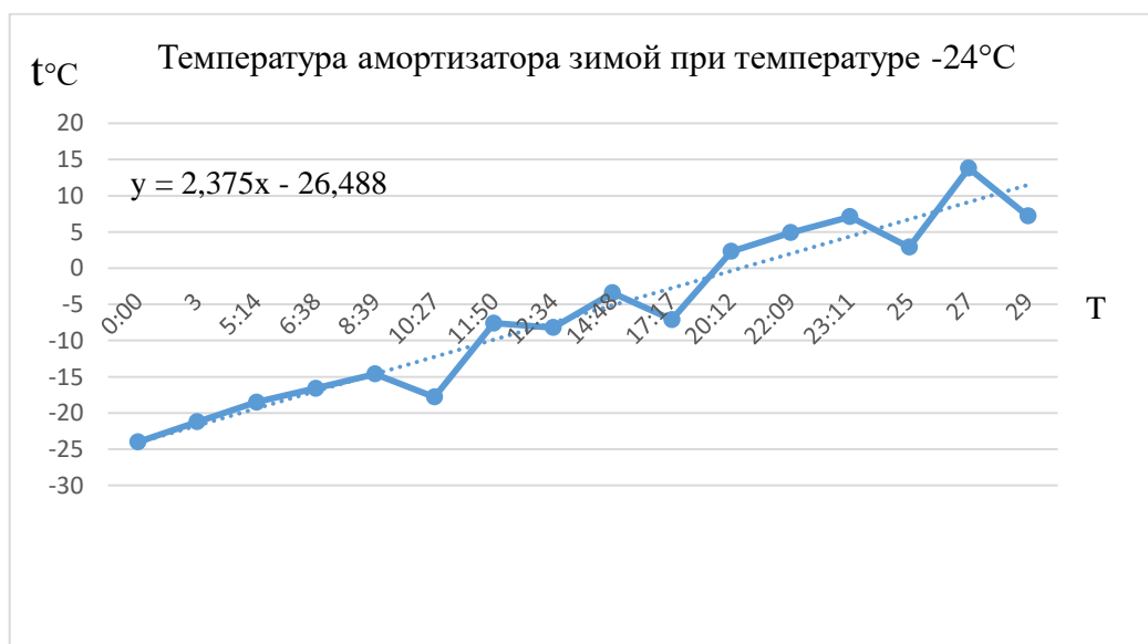
Рисунок 3 - График зависимости нагрева корпуса амортизатора от времени и температуры нагрева нагревательного элемента в условиях зимней полевой эксплуатации
