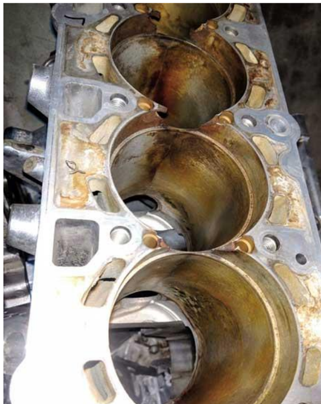
Рисунок 3 – Треснутый алюминиевый блок Audi после гильзовки
