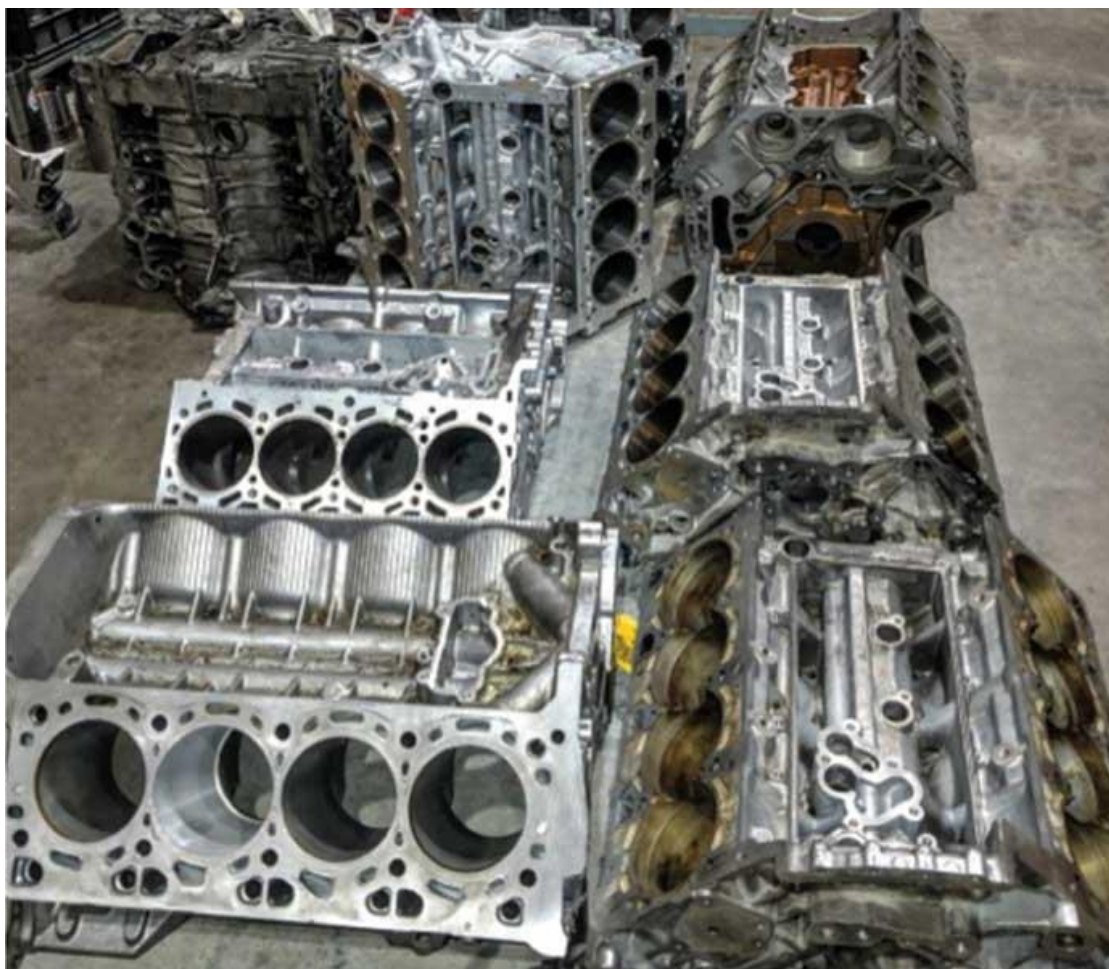
Рисунок 2 – Блоки современных моторов из алюминия с алюсиловым покрытием.
