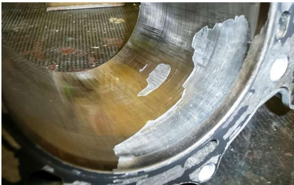
Рисунок 1. Разрушение алюсил-никосилового покрытия на цилиндре алюминиевого блока
