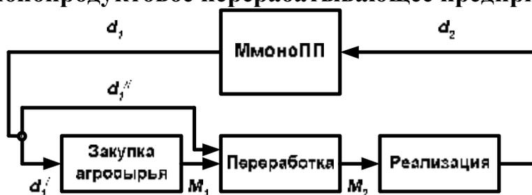
Рисунок 4.2.1 Схема материально-финансовых потоков в малом монопродуктовом перерабатывающем предприятии АПК (МмоноПП)
