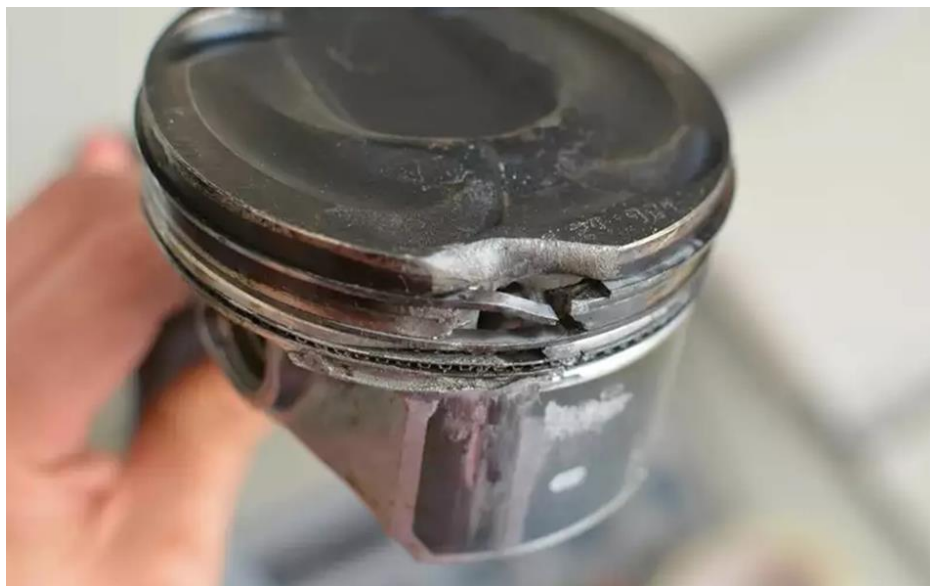
Рисунок 1 – Внешний вид разрушенного в результате преждевременного воспламенения топливоздушнoй смеси (LSPI) поршня двигателя с непосредственным впрыском топлива
