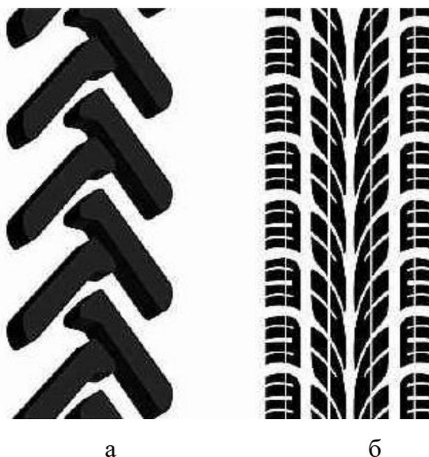
Рисунок 1 – Отпечаток протектора шины трактора (а) и автомобиля (б)
