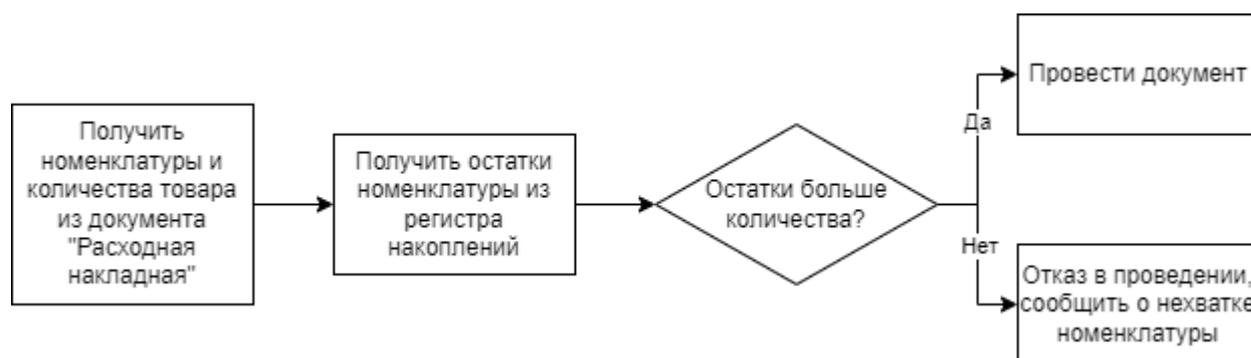
Рисунок 1 – Концептуальная блок-схема алгоритма «Контроль остатков»
