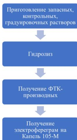
Рисунок 1 - Последовательность этапов анализа согласно схеме №1
