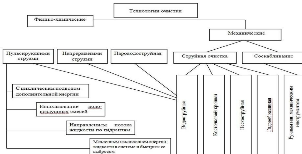
Рисунок 4 –Способы наружной очистки деталей, машин и механизмов[12]
