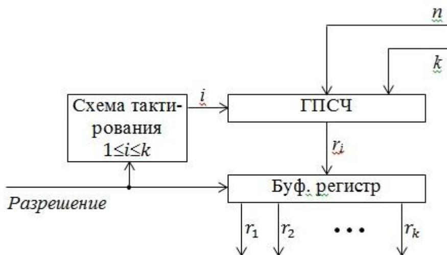
Рисунок 4 – Структурная схема генератора рангов с использованием одного ГПСЧ
