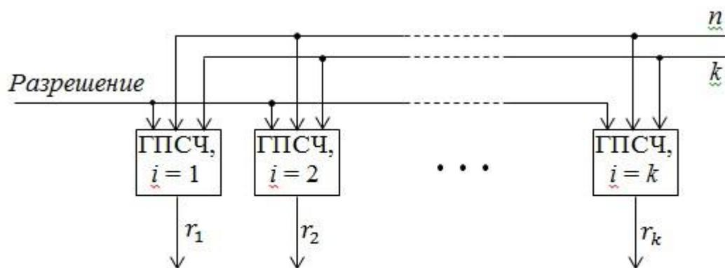
Рисунок 2 – Структурная схема генератора рангов *NP*-системы
