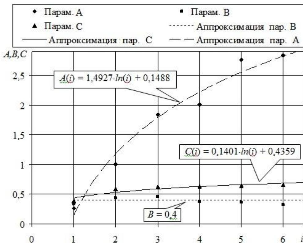
Рисунок 3 – Экстраполяция параметров  $A_i, B_i, C_i$
