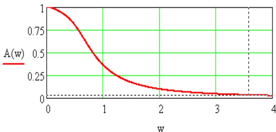
Рисунок 4 – Амплитудно-частотная характеристика замкнутой САУ
