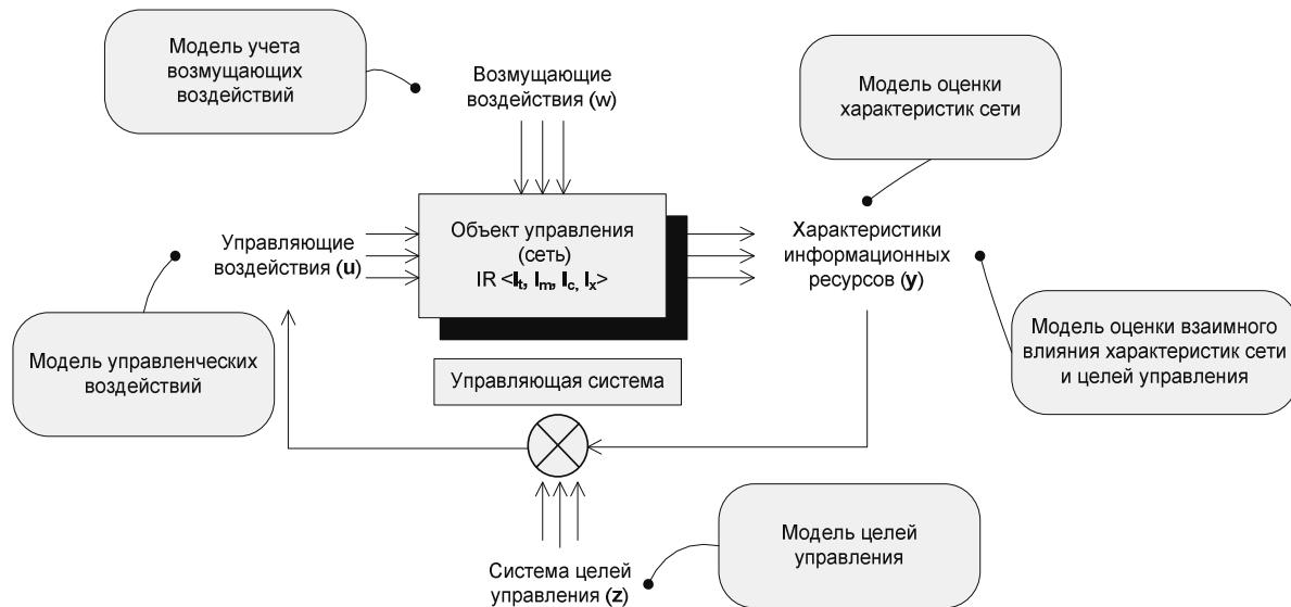
Рисунок 1 - Общая схема системы обнаружения и выявления аномалий в сети
