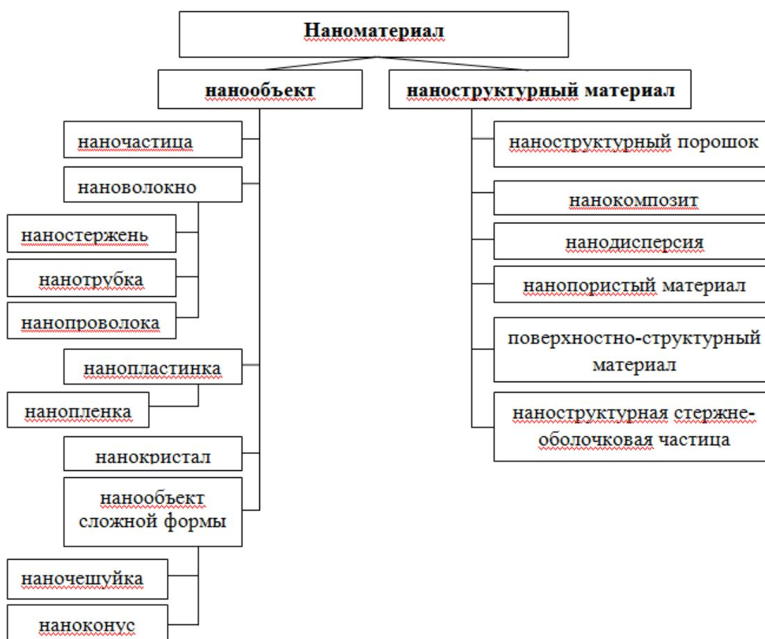
Рисунок 1 – Схема иерархии наноматериалов
