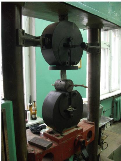
Рисунок 2 – Испытание древесины корней на перерезание на стенде УМ-5А
