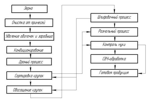
Рисунок 1. Схема предполагаемой технологии производства пшеничной муки
