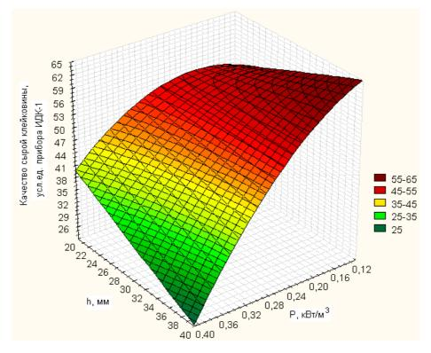
Рисунок 4. Зависимость качества сырой клейковины муки от удельной тепловой мощности СВЧ-энергоподвода и толщины слоя муки
