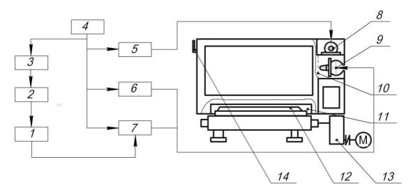
Рисунок 2. Блок схема СВЧ–установки: 1 – реле параметров; 2 – блок управления; 3 – блок защиты; 4 – узел ввода; 5 – блок автоматики магнетрона; 6 – накальный трансформатор; 7 – анодный трансформатор; 8 – вентилятор охлаждения магнетрона; 9 – магнетрон;
