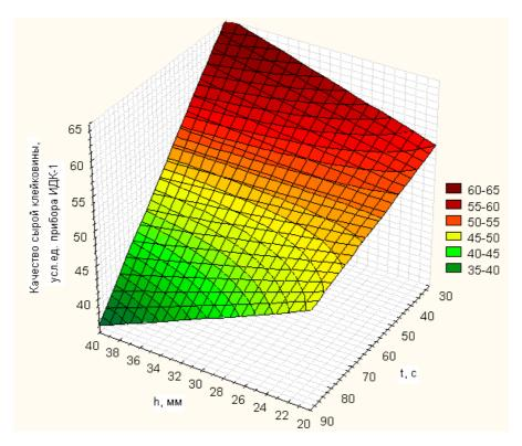
Рисунок 5. Зависимость качества сырой клейковины муки от времени воздействия и толщины слоя муки
