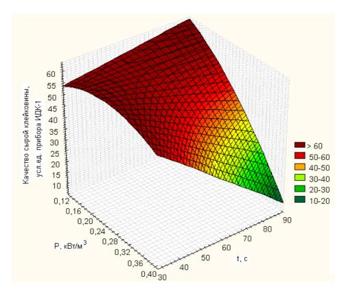
Рисунок 3.Зависимость качества сырой клейковины муки от времени воздействия и удельной тепловой мощности СВЧ—энергоподвода
