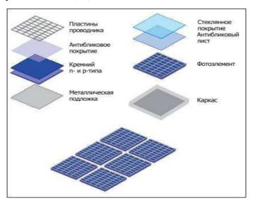
Рисунок 1. Конструкция солнечных панелей
